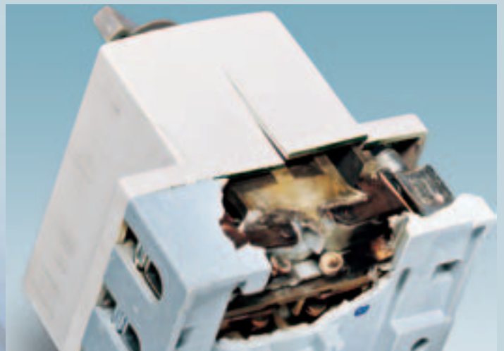
Abb. 1b: Zerstörter FI-Schutzschalter (RCD)
