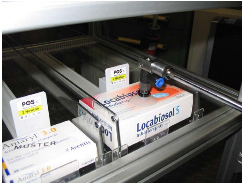
Abbildung 8: Sauggreifer und Warenvorschubsystem
