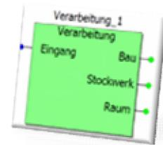
Als erstes wird der Eingangswert vom Datentyp Word nach Integer konvertiert. Mit Hilfe des Vergleichs auf kleiner 1000 wird die Variable erst weitergegeben, wenn der Wert höher ist, sonst wird eine 0 gesendet.
