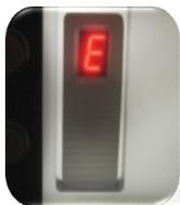
Durch die 7-Segment-Anzeige, welche im Treppenhäusermodul integriert ist, wird das Stockwerk angezeigt. Die Ansteuerung der Anzeige erfolgt durch einen Mikrocontroller. Durch die blinkenden LED's wird er dann auf das zu benutzende Treppenhäuser hingewiesen.
